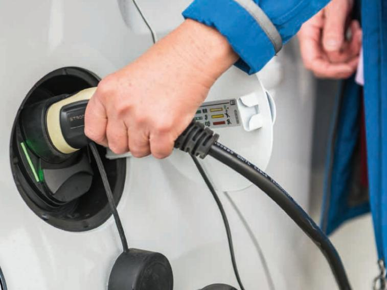
In der Regel interessieren sich die Hausbesitzer für Ladeboxen mit einer Leistung von 11 kW. Diese Leistung entspricht dem, was die meisten E-Autos über ihre Bordelektronik verarbeiten können. Eines der meistverkauften Fahrzeuge, der Renault Zoe (mit 4,5 kWh-Akkukapazität), benötigt an einer Wallbox mit 11 kW heute nur weniger als 1 1/2 Stunden, um 100 Kilometer Reichweite zu tanken. Der Vorteil einer Ladebox zu Hause liegt also auf der Hand und bringt zudem einen Sicherheitsgewinn.
